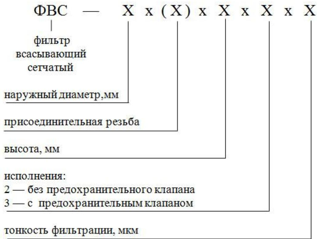
Частичный перечень фильтроэлементов ЭФМГ и всасывающих фильтров ФВС, заменяющих импортные.
