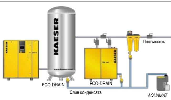
Во всех местах пневмосистемы, где происходит сбор конденсата, должен обеспечиваться его надежный отвод. Наилучшим образом решает эту задачу электронное устройство отвода конденсата.
